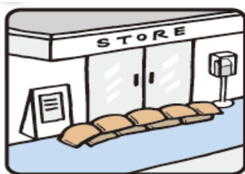
家屋、店舗、車庫等の浸水防止
